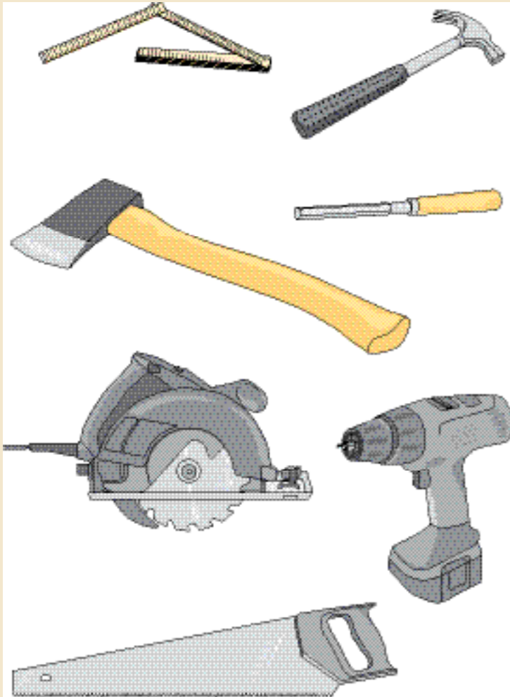
Limträ kan bearbetas med vanliga handverktyg.
